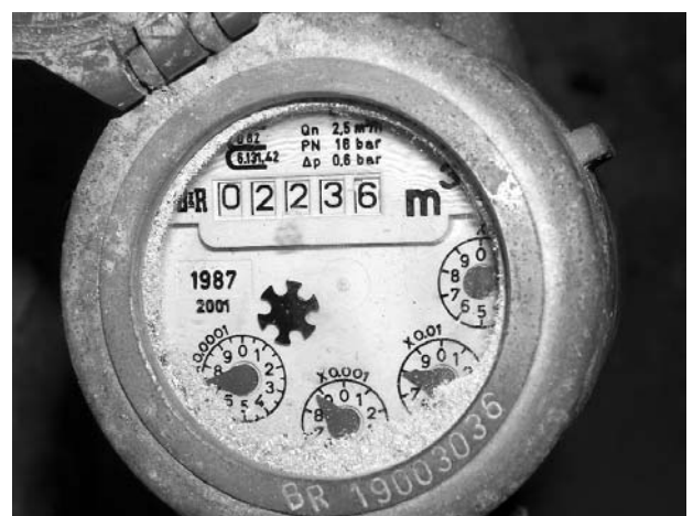
Wasserzähler mit dem Durchflusswert Qn 2,5 m 3 /h. Der Durchflusswert gibt die Zählergröße an, die ab dem 1. Januar 2008 Bemessungsgrundlage für den Grundpreis des Wassers bei den Berliner Wasserbetrieben ist.
